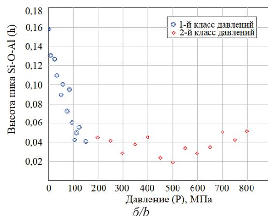
Рис. 4. Корреляционное поле точек зависимости между высотой пика ионной связи (h) и давлением: а) Si-O; б) Si-O-Al; в) Fe-OH
