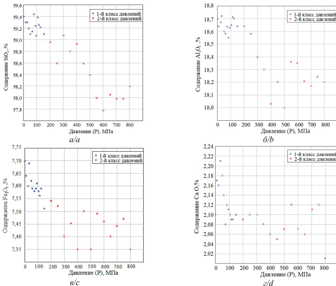
**Рис. 3.** Графики зависимости изменения химического состава бентонитовой глины от давления: а) изменение содержания  $SiO_2$  от давления; б) изменение содержания  $Al_2O_3$  от давления; в) изменение содержания  $Fe_2O_3$  от давления; г) изменение содержания CaO от давления
