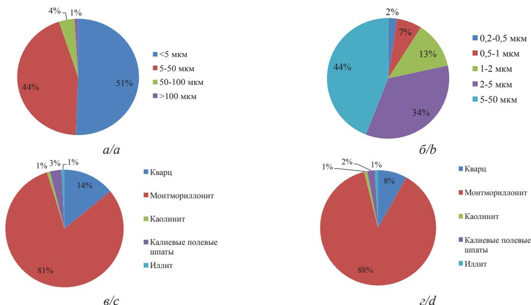
Рис. 1. Гранулометрический и минеральный составы бентонитовой глины: а, в) природной; б, г) обогащенной
