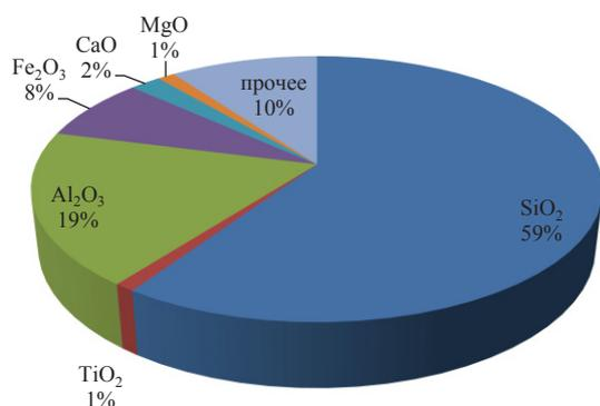
Рис. 2. Массовая доля оксидов, входящих в химический состав бентонитовой глины, %
