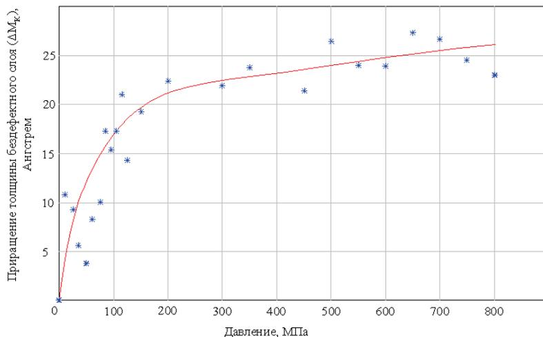
Рис. 5. Влияние давления на изменение толщины бездефектного слоя монтмориллонита
