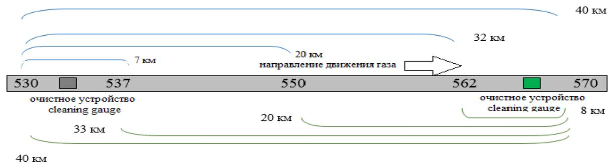
**Рис. 9.** Схема обработки инфразвуковых сигналов
