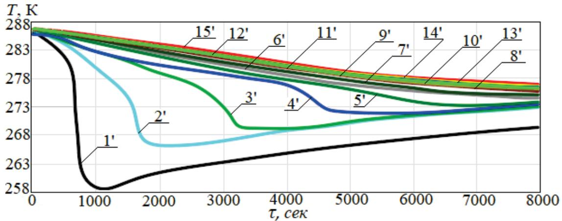
Рис. 3. Зависимости температур в характерных точках поверхности трубы испарителя от времени: 1'–15' номера термодпар, расположенных на поверхности трубы испарителя в соответствии с табл. 1 ( $T_0=286$  K)
