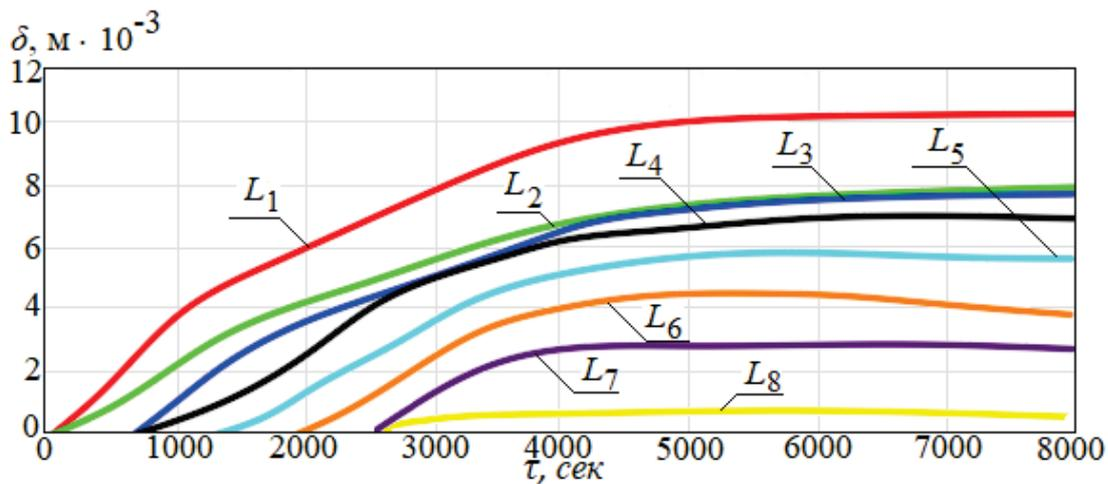
Рис. 4. Изменение со временем толщины льда на трубе испарителя в характерных точках (табл. 2) при  $T_0=280$  K
