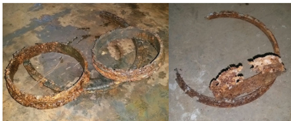
Рис. 4. Коррозионное разрушение уплотнительных колец из стали 20Х13
