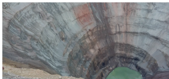
Рис. 2. Водопроявления на бортах кимберлитового карьера «Мир»
