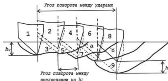
Рис. 3. Механизм разрушения горной породы при вращательно-ударном бурении [15]
